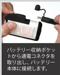
バッテリー収納ポケットから通電コネクタを取り出し、バッテリー本体に接続します。
