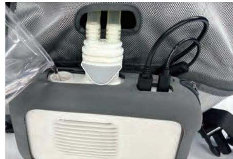
タンクから水を入れ、冷却部を動作させながら、追加で水を注ぎ、水位が安定したらご使用ください。より、冷却効果が感じられます。
